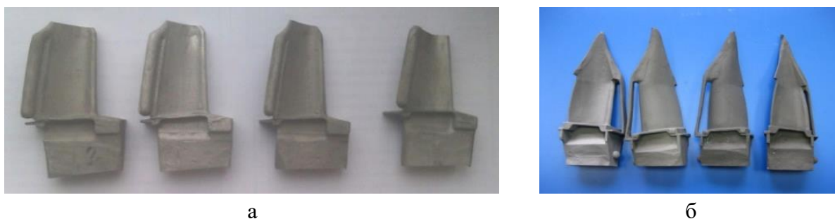
Рис. 15. Отливки рабочих неохлаждаемых лопаток ГТД из сплавов ВКНА-1В (а), ВКНА-25 (б)
